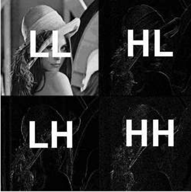
Şekil 1. İki boyutlu bir verinin bir seviyeli DWT dekompozisyonu sonucu oluşan alt bantlar.
